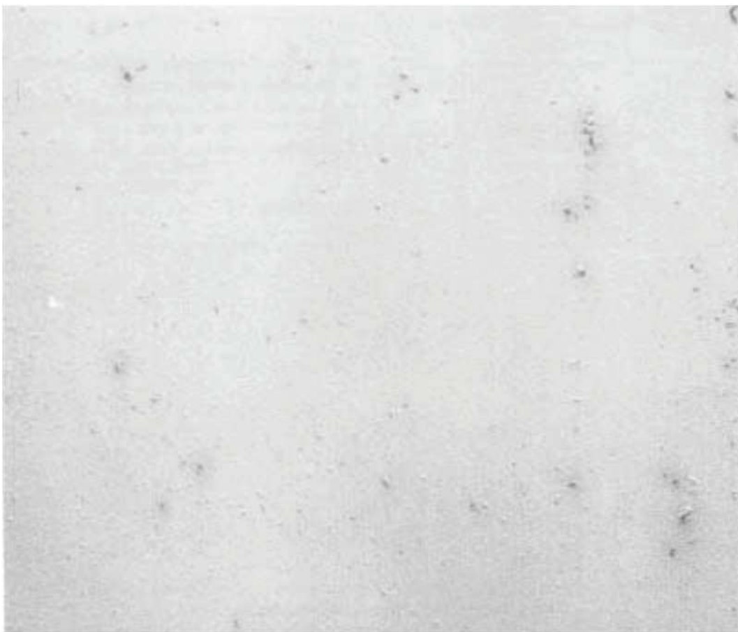
Рисунок 10 – Коррозия металла балл Ri2
