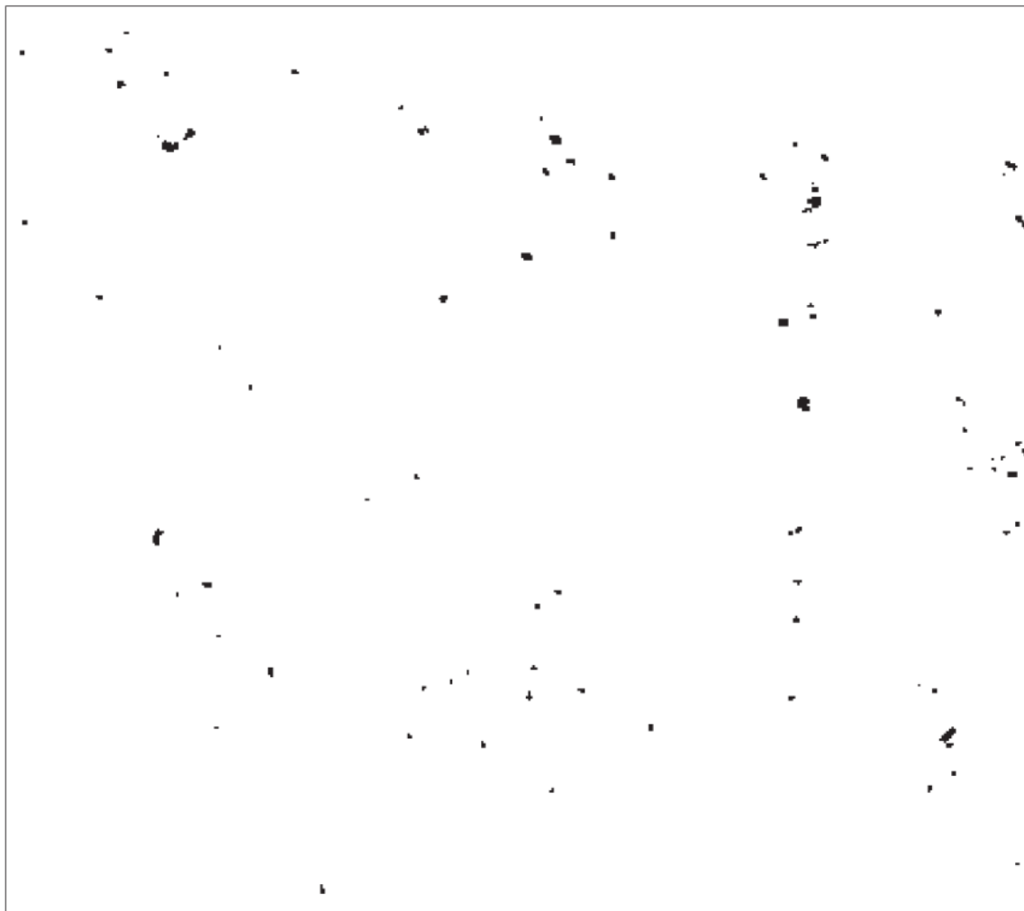
Рисунок И.2 – Коррозия металла балл K2 (или Ri 2)
