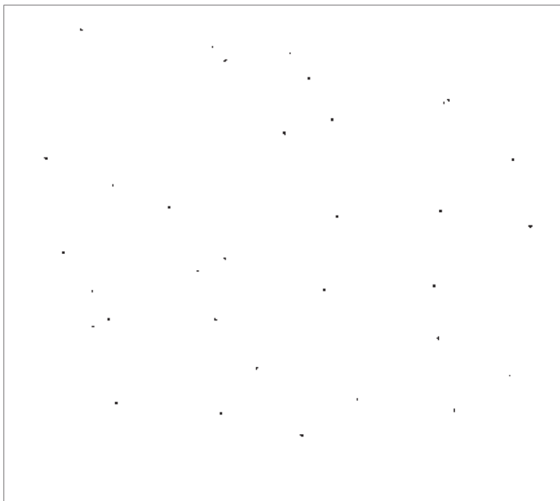
Рисунок И.1 – Коррозия металла балл K1 (или Ri 1)
