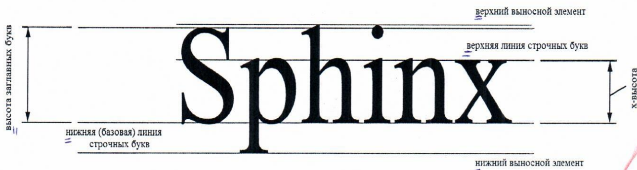
Рисунок А.1 — Соотношение между х-высотой и высотой заглавных букв, верхними выносными элементами, нижними выносными элементами, нижней (базовой) линией строчных букв и верхней линией строчных букв
