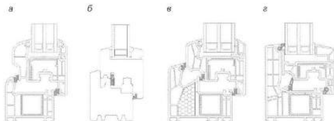
Рисунок 2 – Основные типы конструкций и варианты заполнения светопрозрачной части оконных блоков
