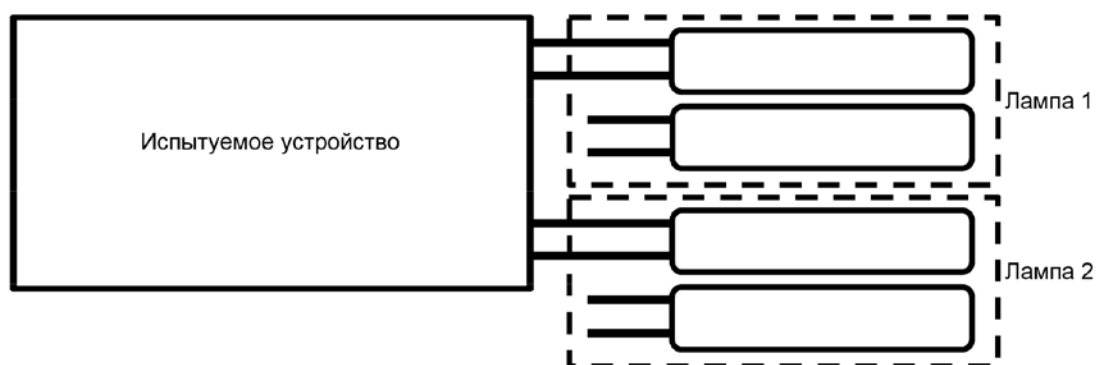
Рисунок 9 — Схема для испытания ламп без стартера
