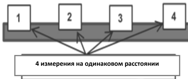
Рисунок Д.1 – Схема измерения величины остаточной магнитной индукции в листе по варианту I
