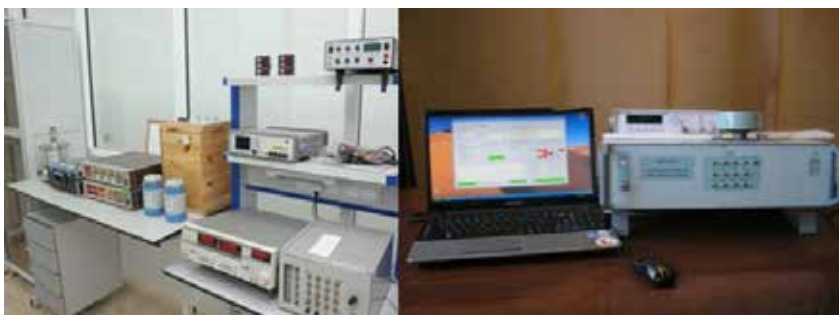
Рисунок 4.2.15 - Государственный эталон единицы электрической емкости
