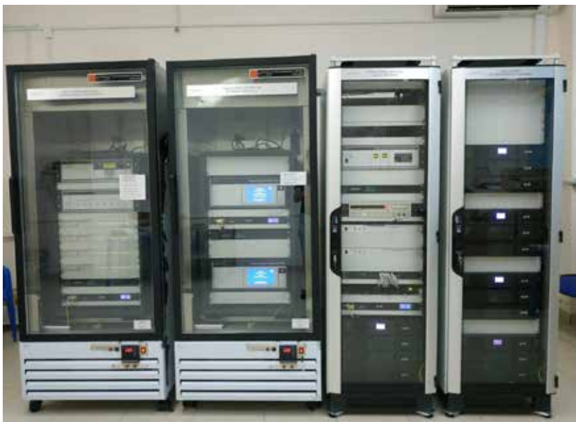
Рисунок 4.2.18 - Государственный эталон единицы времени и частоты
