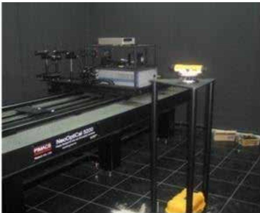
Рисунок 4.2.13 - Государственный эталон единицы координат цвета и координат цветности
