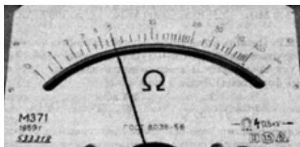
Рисунок 1.7 – Шкала омметра класса точности 1,5
