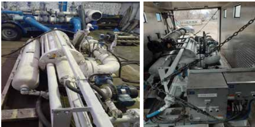
Рисунок 4.2.6 – Государственный эталон единицы расхода жидкости
