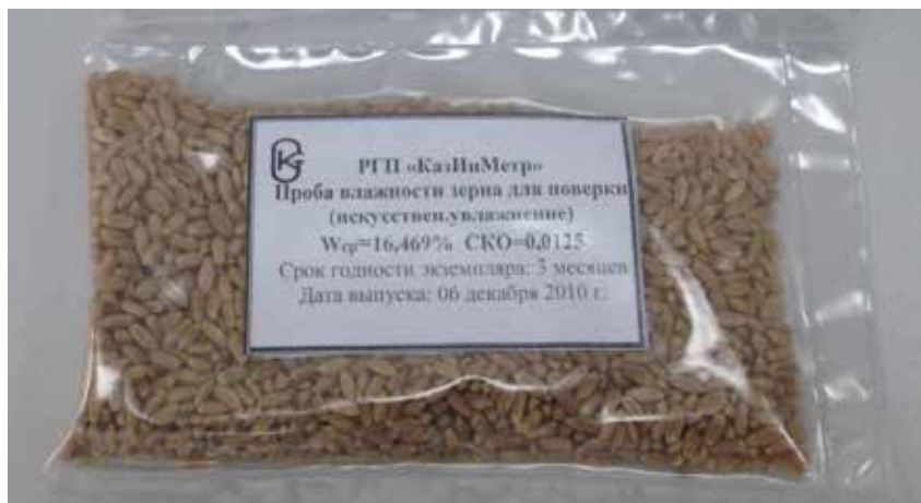
Рисунок 4.3.3 Государственный стандартный образец влажности зерна и зернопродуктов
