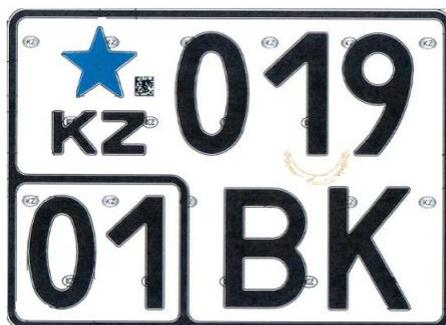
Тип 2Б - задний номерной знак для легковых грузовых автомобилей и автобусов органов военной полиции ВС РК руководства Министерства обороны, место для крепления которого не соответствует габаритам номерного знака тип 1Б
