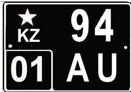
Тип 5Ч - номерной знак для прицепов и полуприцепов транспортных средств ВС РК
