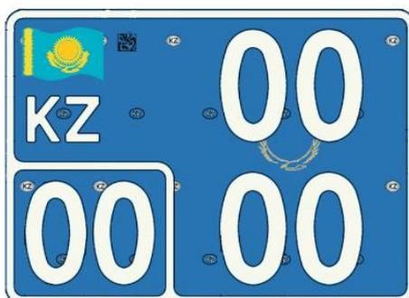
Тип 2С – задний номерной знак для легковых и грузовых автомобилей специальных и оперативных служб органов Министерства внутренних дел, место крепления которых не соответствует габаритам номерного знака тип 1С
