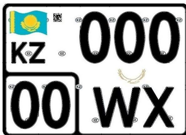
Тип 2 - двустрочный задний номерной знак серии «WX» для грузовых автомобилей и автобусов Службы государственной охраны РК, а также для легковых автомобилей Службы государственной охраны РК, место крепления которых не соответствует габаритам номерного знака типа 1
