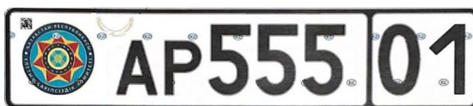
Тип 1 серия «AP» - номерной знак для легковых автомобилей и передний для грузовых автомобилей и автобусов военной полиции КНБ РК
