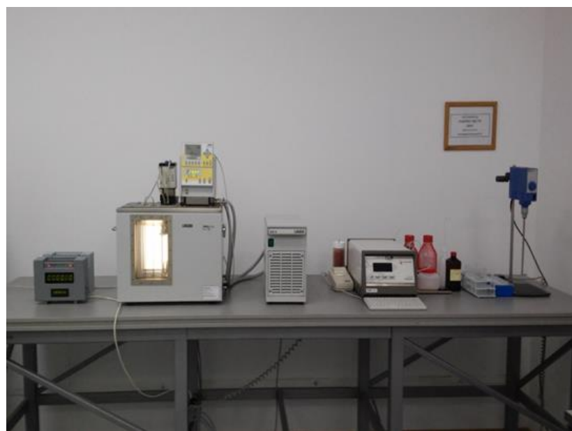
Рис. 1 - Государственный эталон единицы кинематической вязкости жидкости
