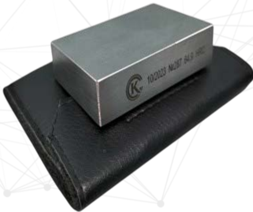
■ Рисунок 6 – Мера твердости МТР-К 64,9 HRC
